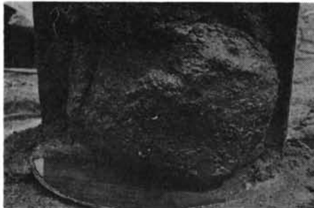
写真—11 打設されたコンクリート塊（直径1.26mの実験ソウに粗砂50cmと細砂50cmを入れた実験）
