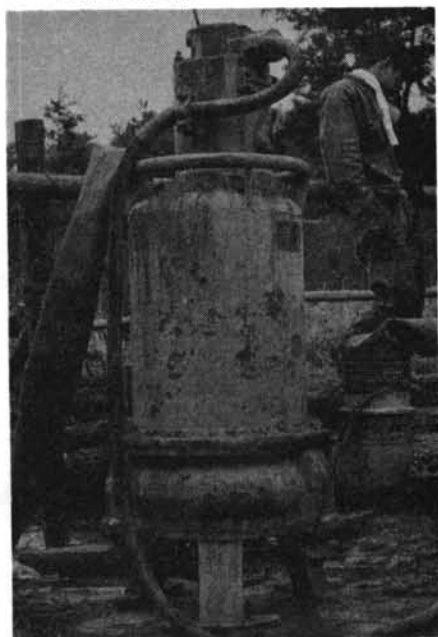
写真一6 吸上げ試験に用いた水中サンドポンプ (桜川HS-6425型)
