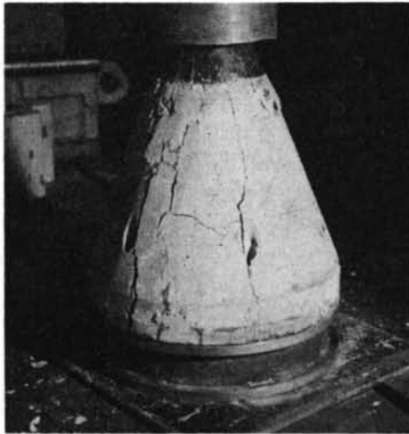
写真-4 P・C 350-1 破壊状況
