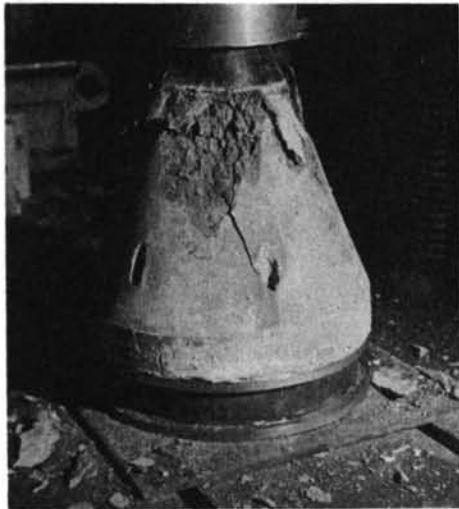
写真-5 P・C 350-3 破壊状況
