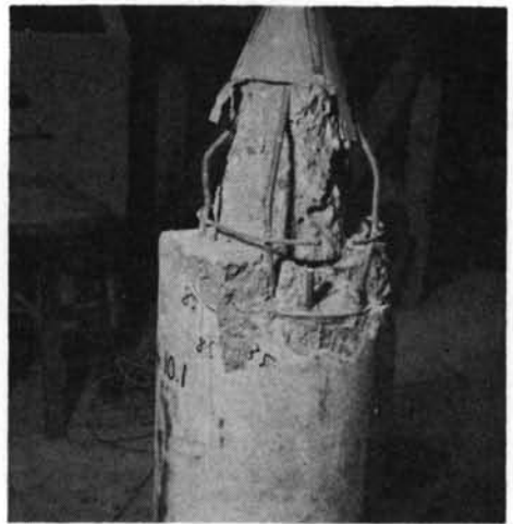
写真-3 R・C 300-1 破壊断面
