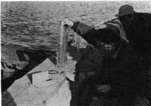
写真一8 船上でブリージングおよび膨張の測定
