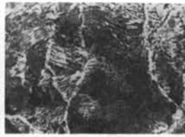
写真六 融合部と溶着金属の境界付近 ( \times 120 , 5%ナイタル, 30sec)
