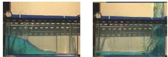
(a) 崩壊直後の底面流れ (b) 右壁への打ち上がり
