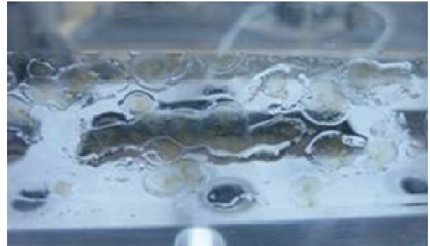
写真-1 スリット内でゲル化した溶液型グラウト
