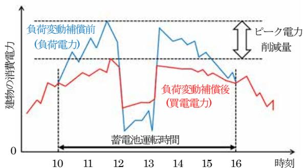
図-1 蓄電池の負荷変動補償例
