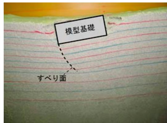
写真-2 液状化で傾斜した構造物直下の地盤変形
