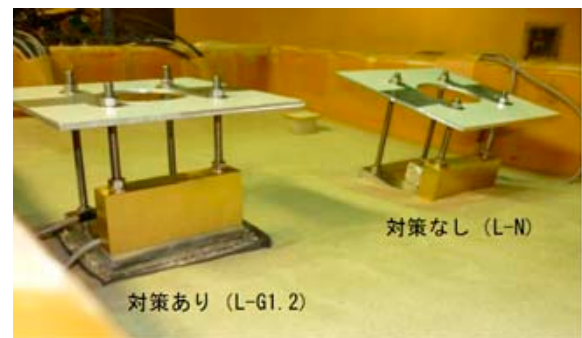
写真-3 加振終了後の構造物の状態 (基礎下礫と無対策)
