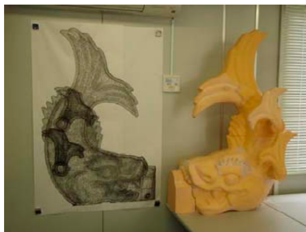
図-8 実大寸法図と鋳型原型
