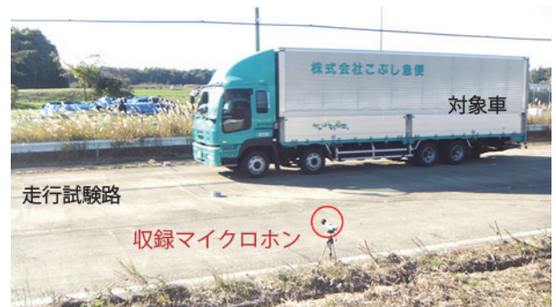
図-7 自動車走行音測定状況
