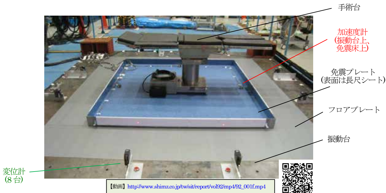
写真-1 免震床試験体
