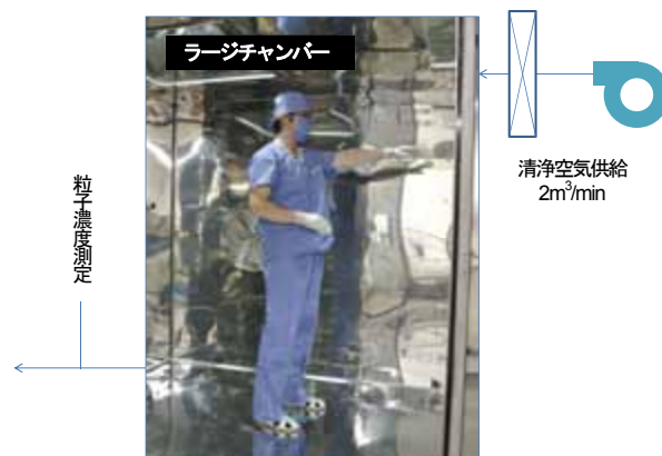
図-10 模擬手術時の人体由来総発塵量の測定方法
