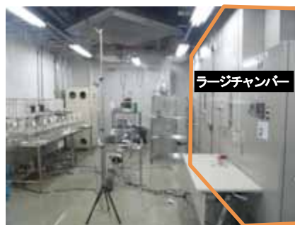
写真-3 人体発塵量測定に用いたラージチャンバー
