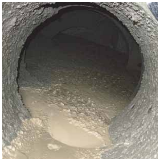
写真-2 アジテータ車内のスラリーの様子
