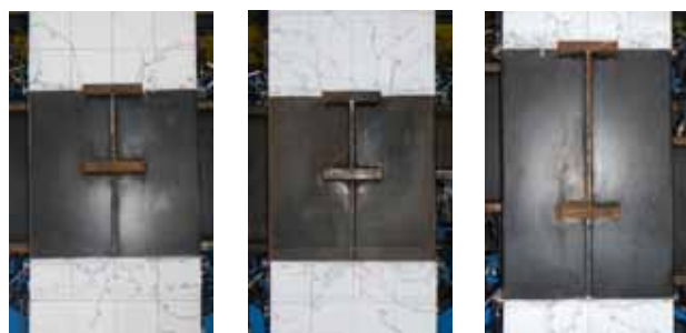
写真-1 試験体ひびわれ状況( R=+2.0\% ピーク時)
