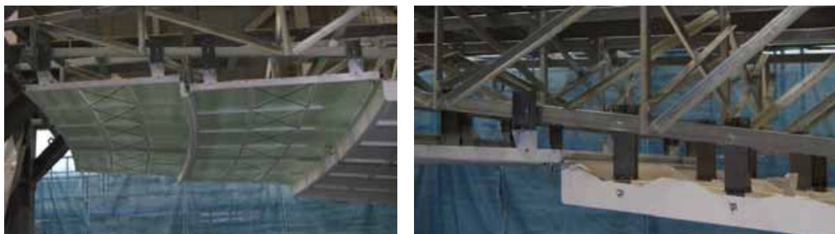
写真 - 8 芳賀観測波での加振後の試験体状況(無損傷)
