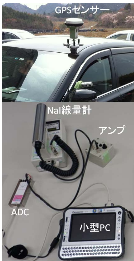
図-4 GPS モニタリングシステム機器一式の写真
