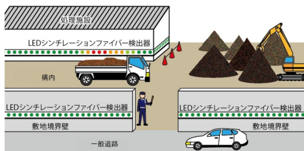
図-20 施設や敷地の境界におけるLEDシンチレーションファイバー検出器の適用イメージ
