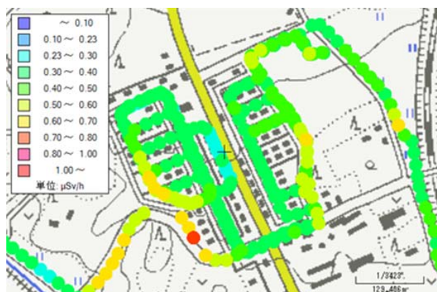
図-6 車両に搭載したGPSモニタリングシステムにより福島県内の住宅地域で線量率を測定した結果
