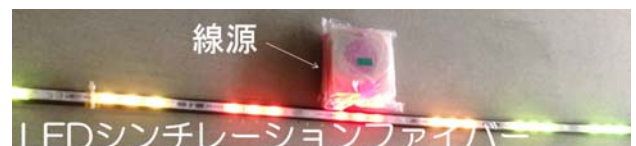
図-16 線源による LED 色表示の例
