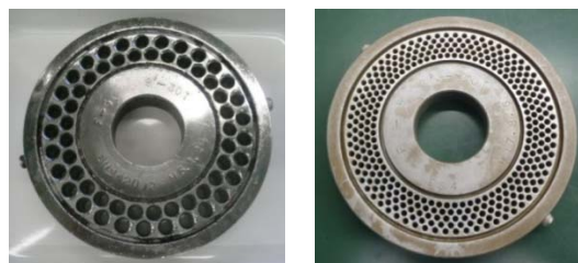
図-6 押し出し造粒機のダイス（左：8mm、右：3mm）
