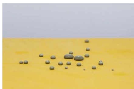
写真-5 セメントスラリーの撥水状況（超撥水加工した塗装合板）
