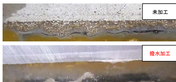
写真-14 撥水加工の有無による脱泡状況（水）
