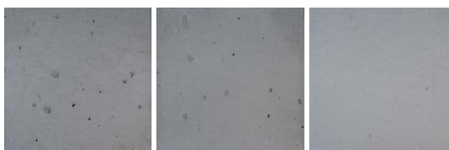
接触角約80° 接触角約130° 接触角150°超 写真-12 表面気泡
