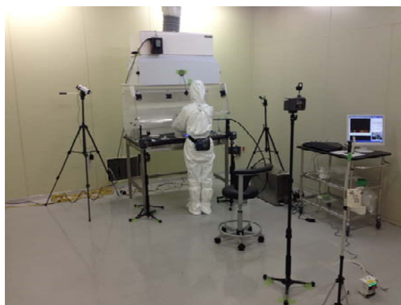
写真-1 秤量用エンクロージャー(写真中央)を使用した検証実験の様子
