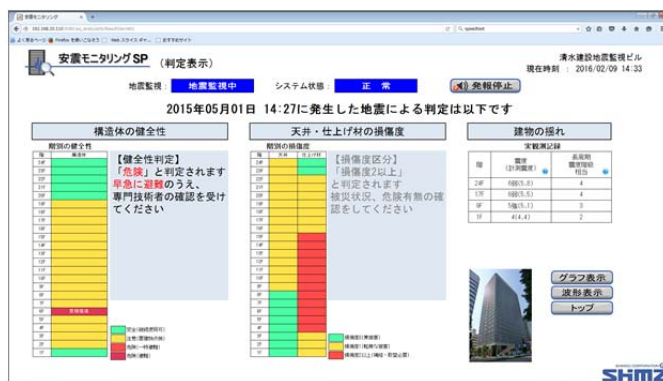
(a) 健全性損傷判定画面
