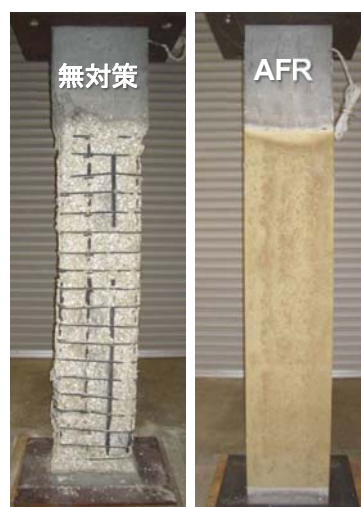
写真－1 超高強度コンクリート部材の耐火性
