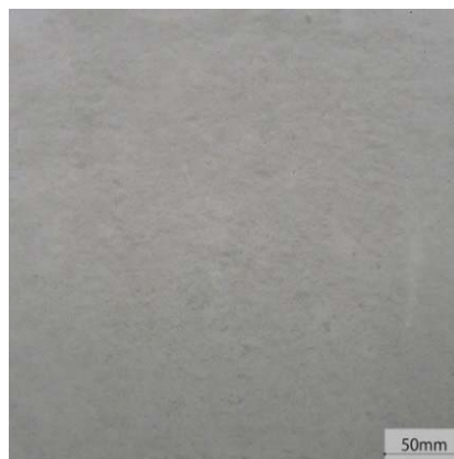
接触角 150°超の型枠（アート型枠）
