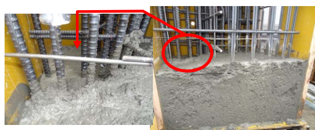
図-20 加振後の未充填部分へのコンクリートの流入状況(実験結果)
