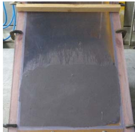
写真-3 鉄筋のない場合の加振5秒間の充填状況
