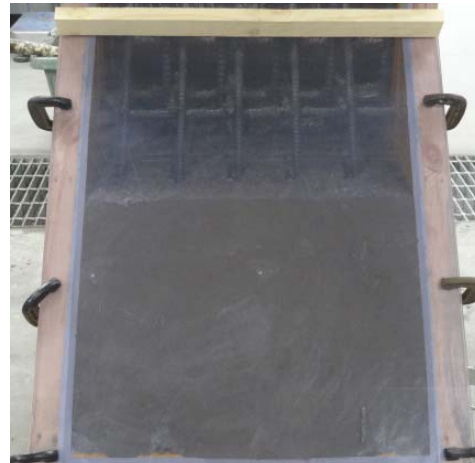
写真-5 加振15秒間のコンクリートの充填状況
