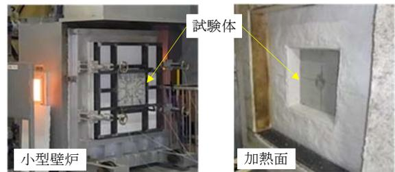
写真-2 加熱実験装置と試験体設置状況
