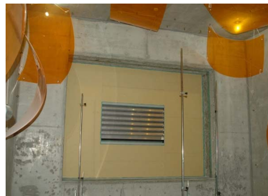
図-7 音響透過損失試験の状況
