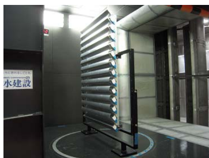
図-13 風切り音実験の状況
