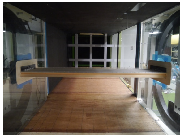
図-4 部分模型の設置状況
