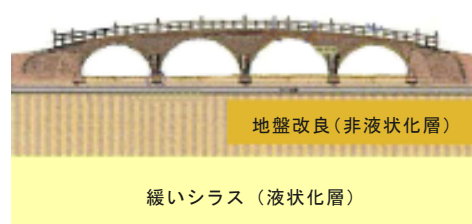
図-4 石橋の地盤構造
