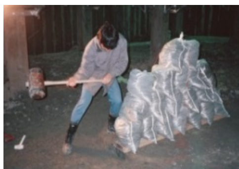
写真-2 板たたき法による地盤剛性の調査 （掘削深さごとに掘削底で調査）
