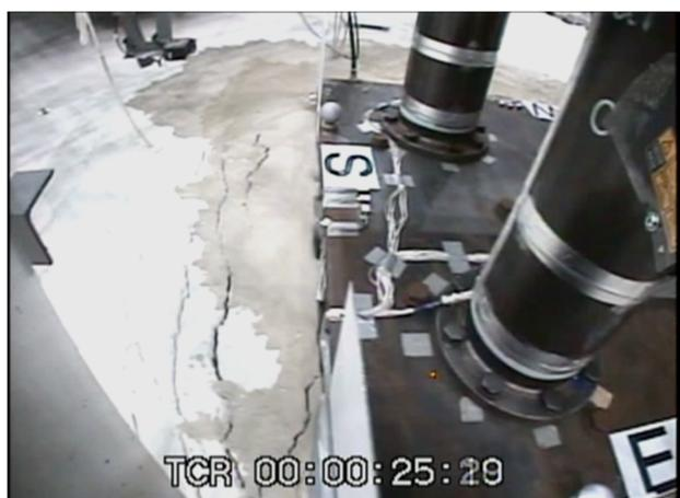
写真-1 加振中のフーチングと噴砂の状況
