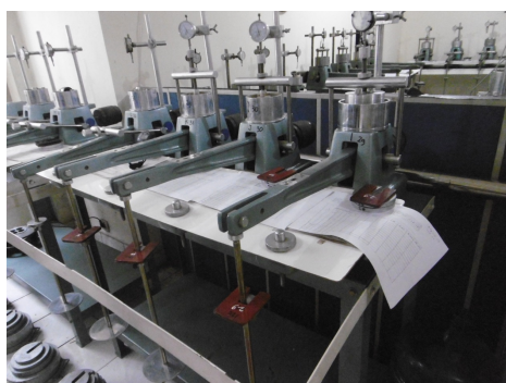
写真-4 膨張性試験の試験状況
