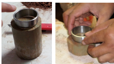
写真-5 円筒形リングへの膨張性地盤の装填
