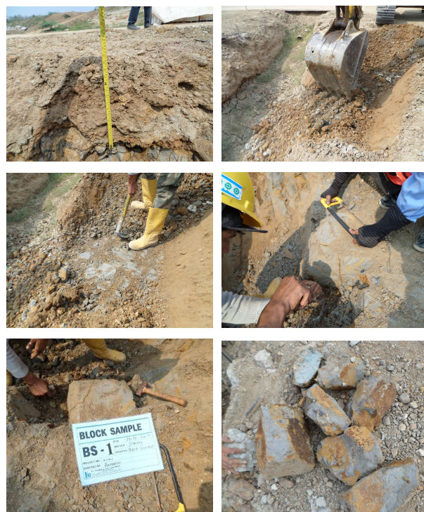
写真-8 膨張性地盤のサンプリング状況
