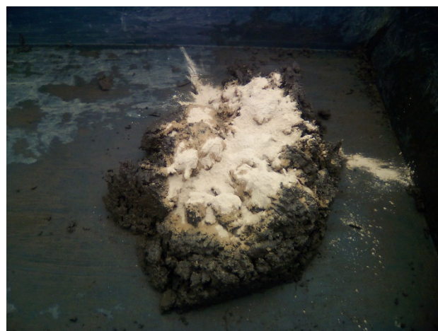
写真－9 元土に SC カラッ土®を添加した様子
