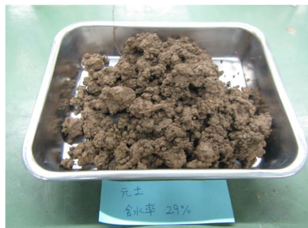
写真-5 含水率 29%に調整した元土
