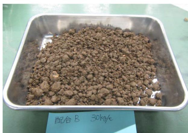
写真－8 SC カラッ土®改質土
