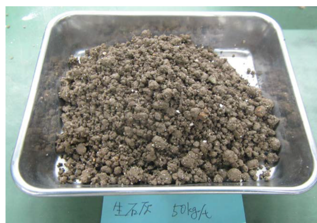
写真-7 生石灰混合改質土
