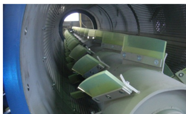
解砕羽（中央半透明の部品）を外周に配した回転ドラムがふるいを有する回転ドラムの中に設けられている
