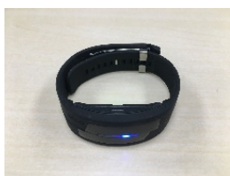
仕様抜粋 搭載センサ: 脈拍センサ(光電式)、3軸加速度センサ(MEMS) 検出量: 脈拍、消費カロリー、歩数、加速度 無線方式: BLE(2.4GHz帯) 電源: バッテリ
