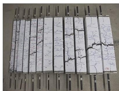
(b) 鉄筋補強したFRCC
