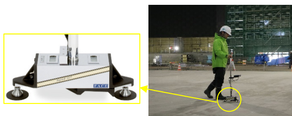
写真-9 Floor Profiler による測定状況
