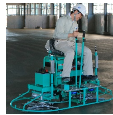
アクティブ ATR22L 金鍍作業用(重量 220kg)
