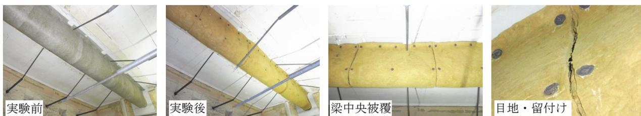
写真-6 試験体 No.5：実験前後の状況
