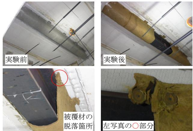
写真-2 試験体 No.1：実験前後の状況
