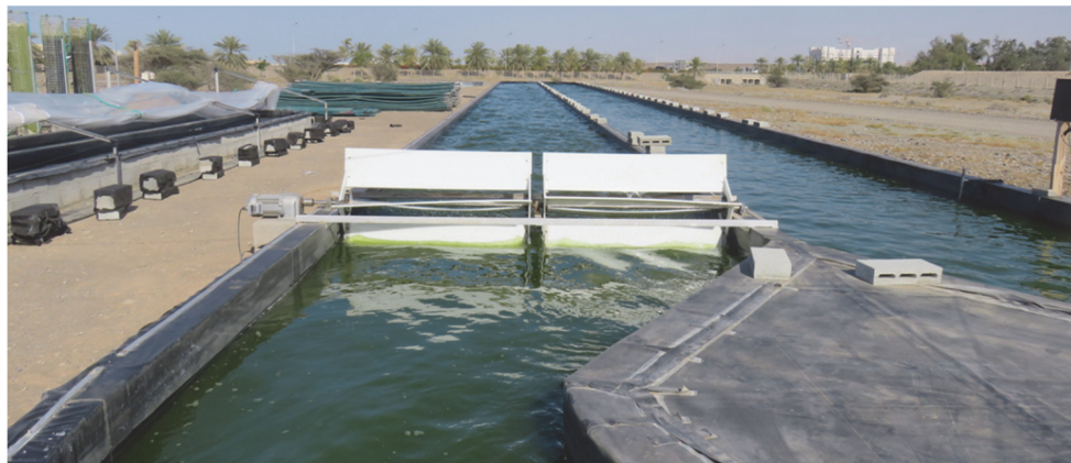
写真-1 400 m 2 レースウェイでの培養の様子
