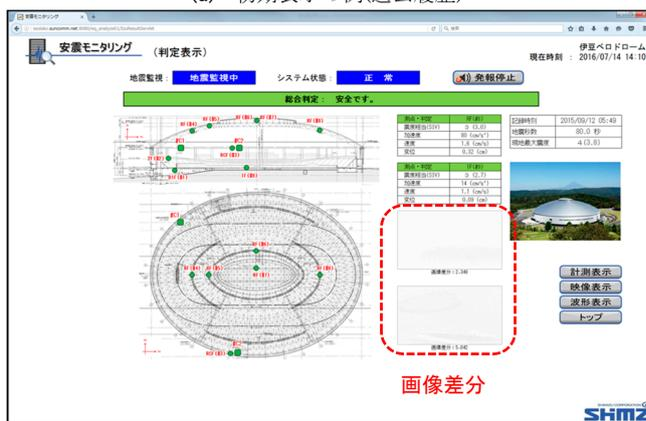
(b) 判定表示の例(加速度、計測震度、映像差分表示)
