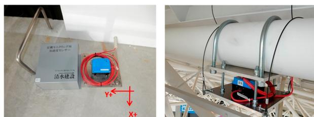
(a) 床面にアンカーボルト固定 (b) U字ボルトで吊下げ固定
