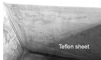
写真-1 テフロンシートを貼り付けた土槽側面
