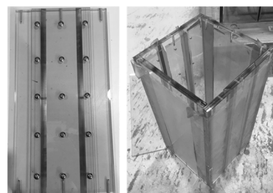
写真-3 格子状改良体の型枠
