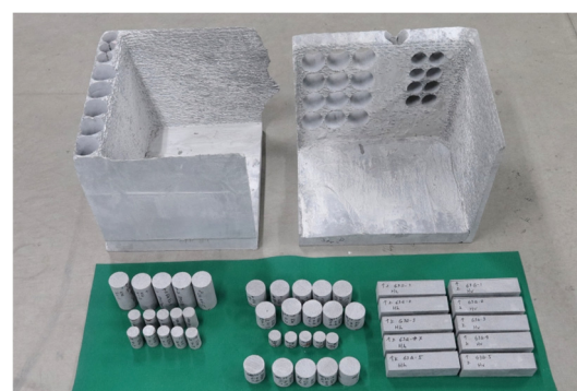
写真-4 積層体から採取した供試体
