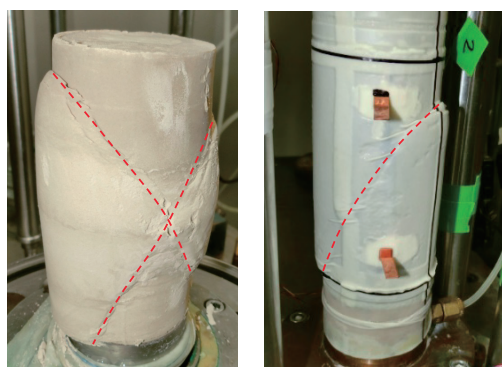
(a) X型 (b) たすき型 写真-1 三軸圧縮試験後の供試体状況
