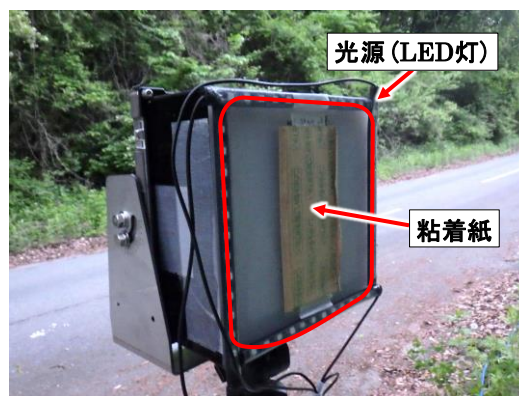
図-10 異なる点滅周期での誘虫試験装置 (粘着紙前面の剥離紙を剥がすと透明な粘着面が現れる)
