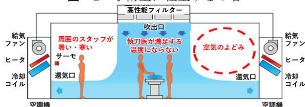
図-3 従来システムによる空調気流
